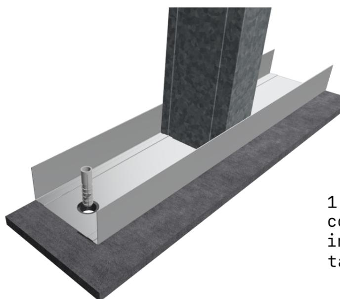
1. Realizamos una perforación con ayuda de un taladro e insertamos en el orificio un taco Nylón.
