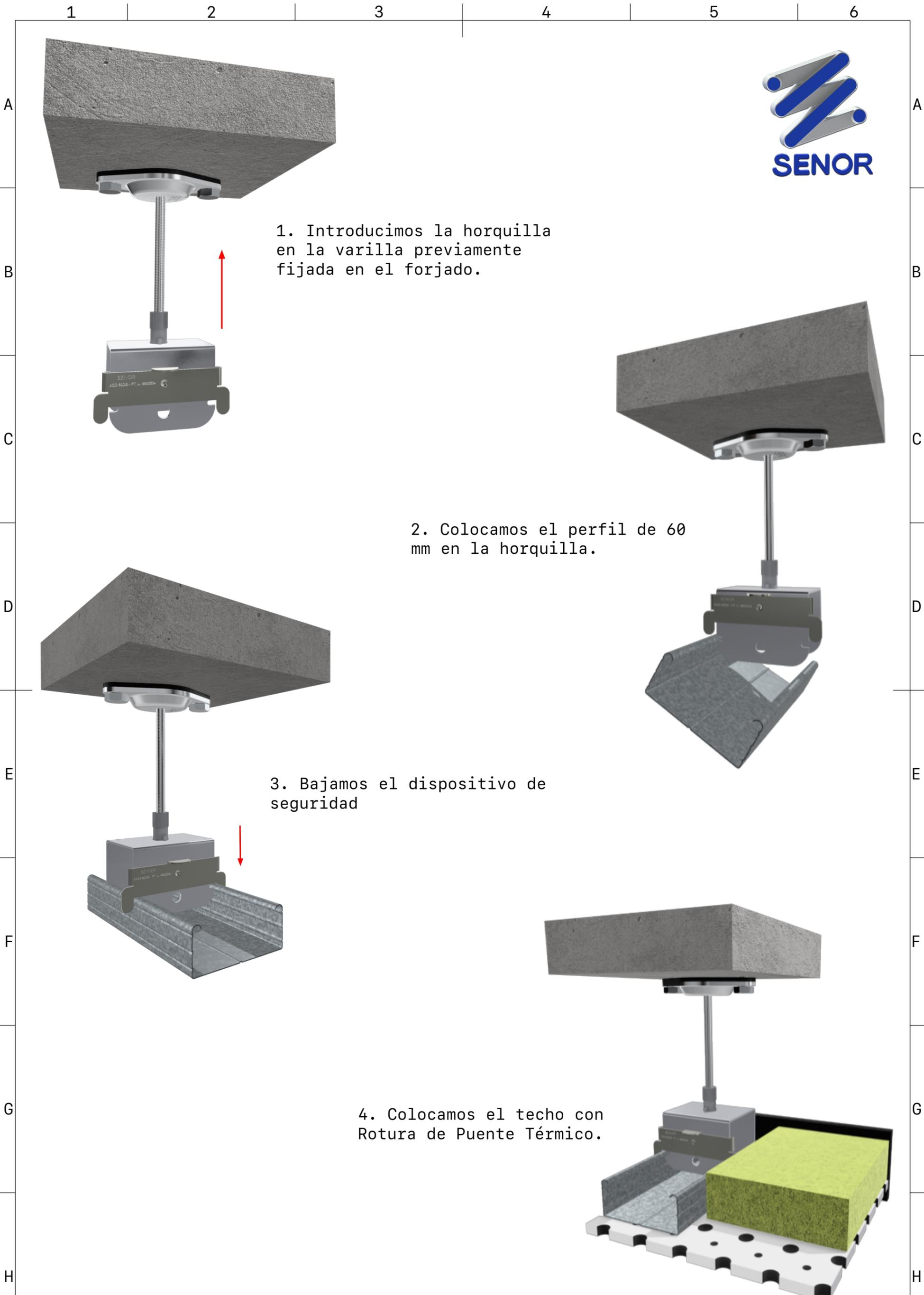
1. Introducimos la horquilla en la varilla previamente fijada en el forjado.
