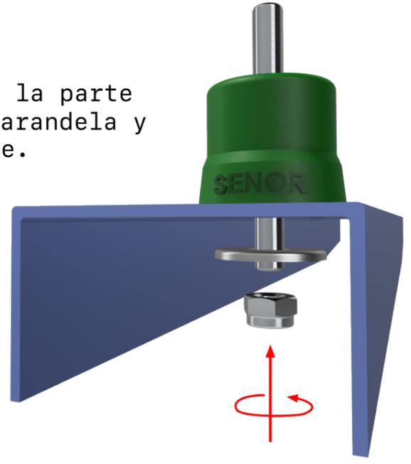
2. Fijar el BF por la parte inferior mediante arandela y tuerca autoblocante.
