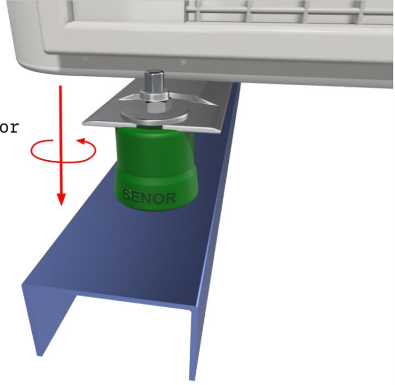
4. Sujetar la parte superior del BF al equipo mediante tuerca autoblocante y arandela.
