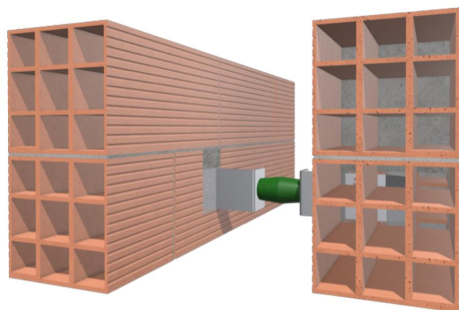
3. Sellamos los trozos de ladrillo al amortiguador con cemento.
