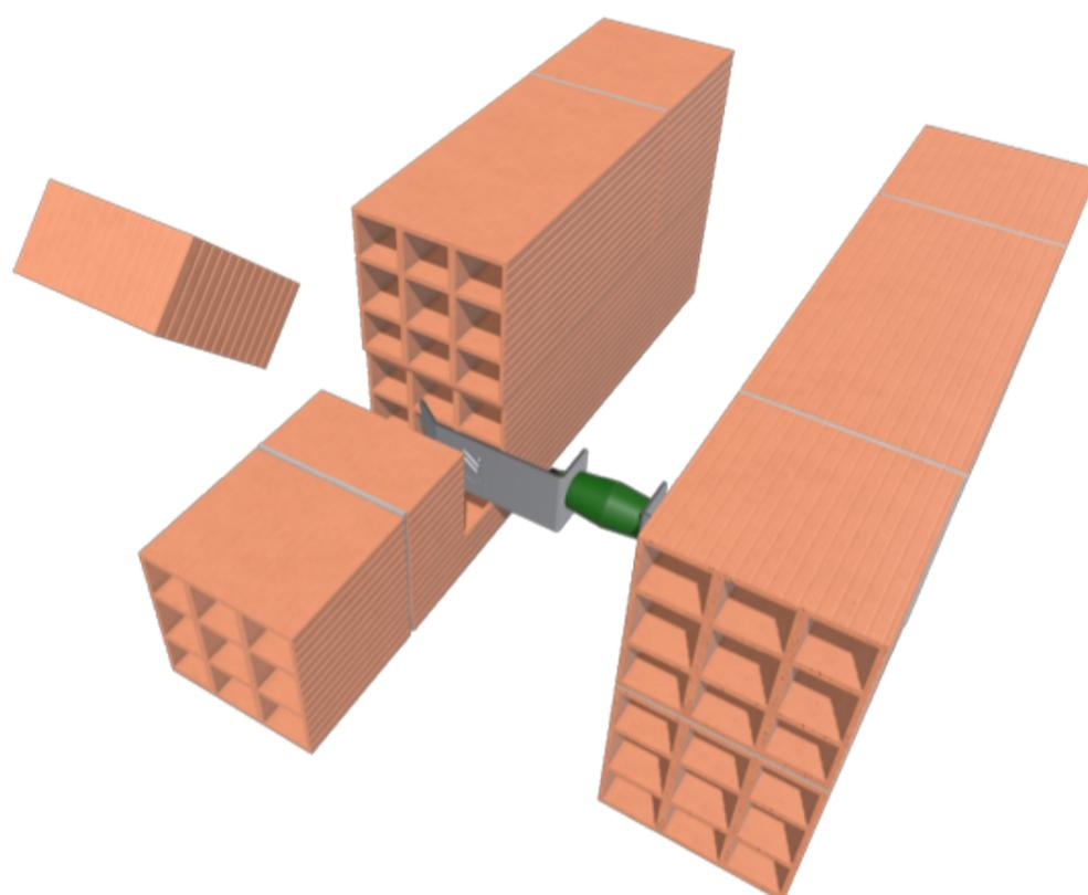
2. Construimos un nuevo muro cerámico y volvemos a fragmentar el ladrillo para introducir el amortiguador.
