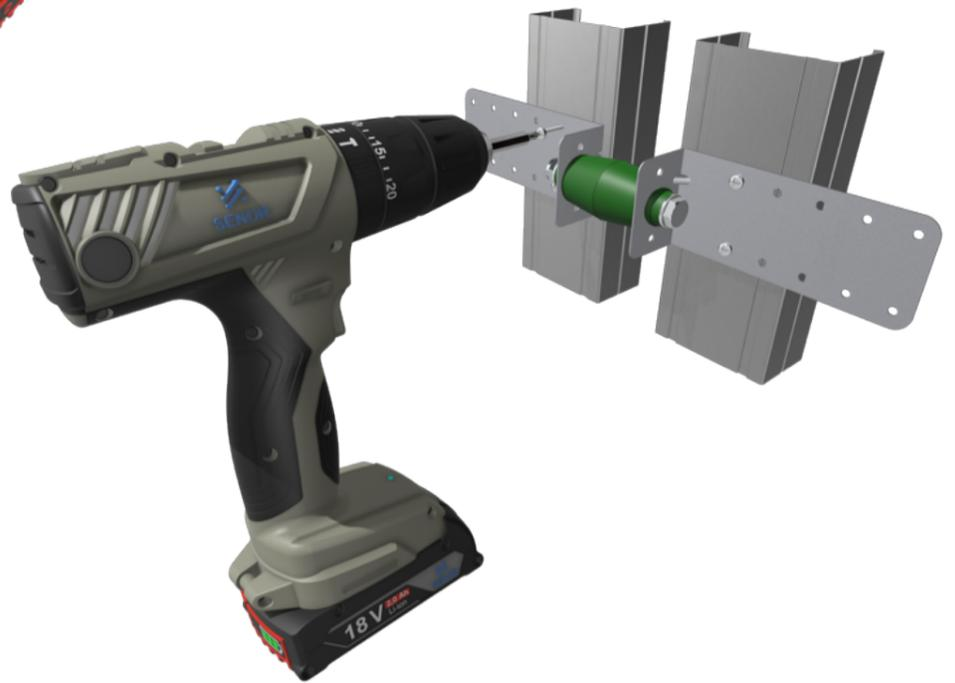
2. Atornillamos el segundo perfil al otro lado del aislador.
