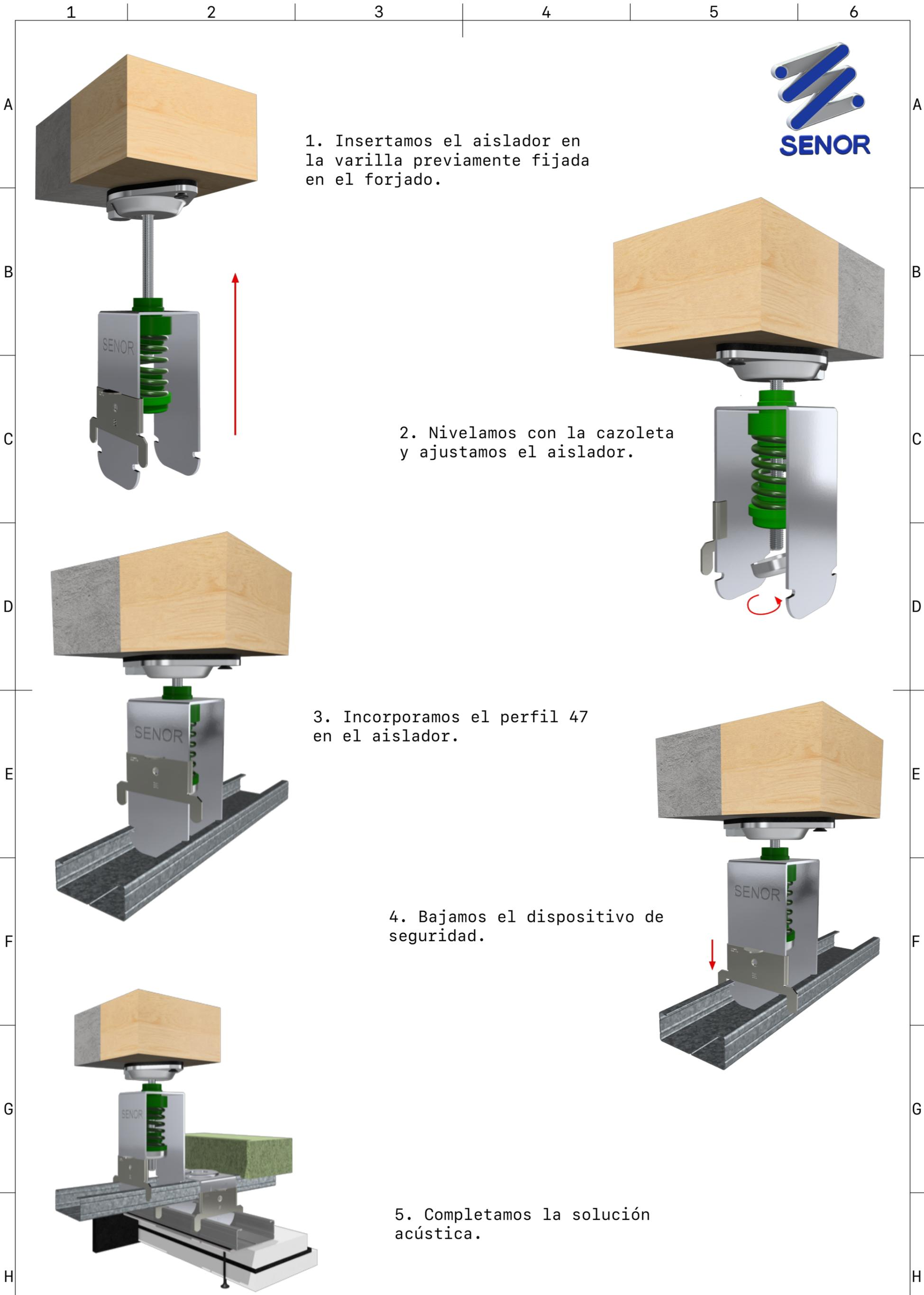
1. Insertamos el aislador en la varilla previamente fijada en el forjado.
