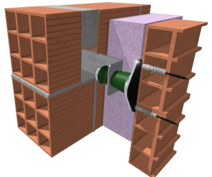
4. Rellenamos el hueco entre muros con lana de roca.
