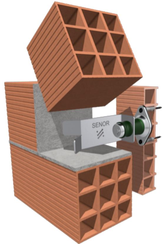
2. Levantamos el nuevo muro cerámico acústico.
