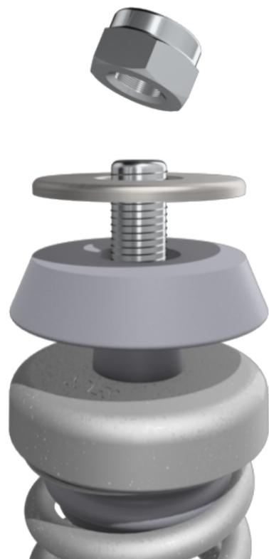
1. Retiramos del amortiguador TBMF la tuerca autoblocante + arandela metálica + arandela de protección polimérica.
