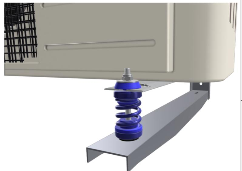
4. Posicionamos la arandela de goma, la arandela metálica y la tuerca autoblocante SOBRE LA PATA DEL EQUIPO y ajustamos para su fijación.
