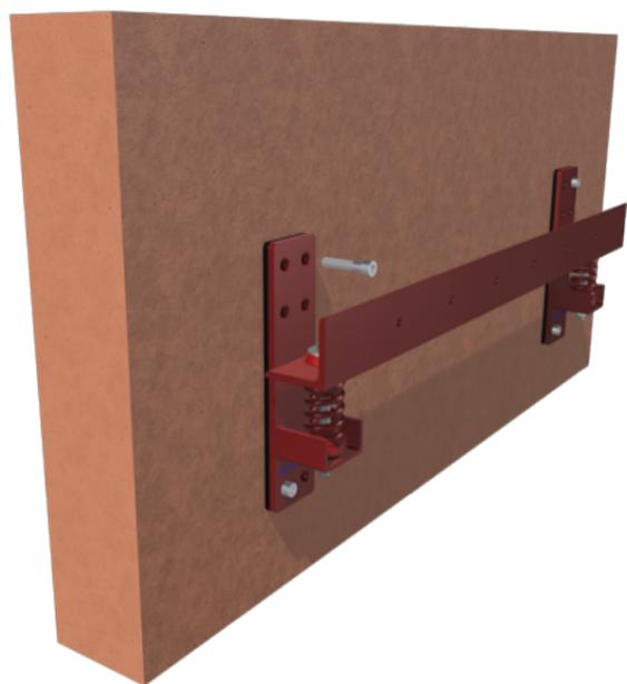
1. Fijamos el aislador a la pared (con taco químico, taco hormigón, taco nylon, etc.)
