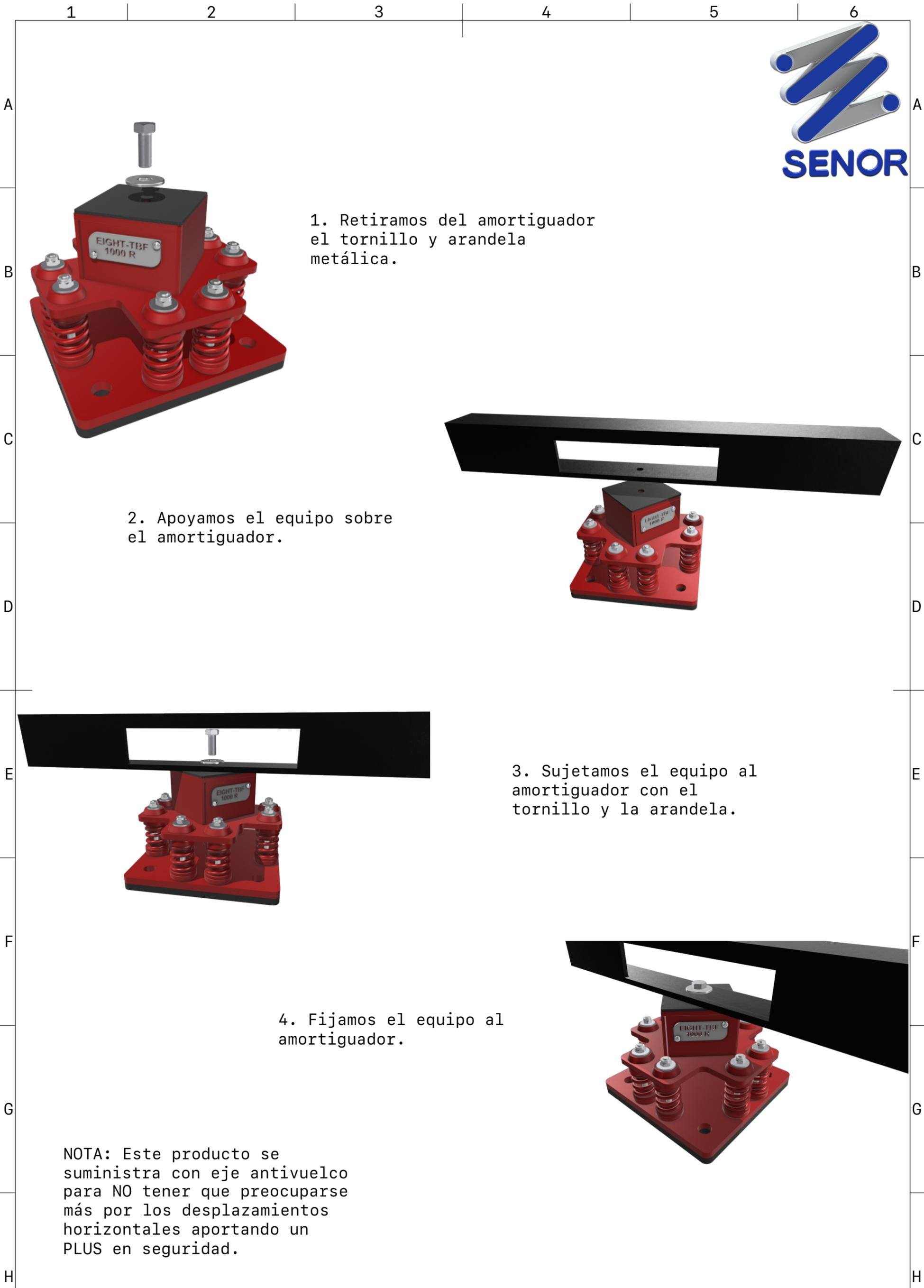
1. Retiramos del amortiguador el tornillo y arandela metálica.
