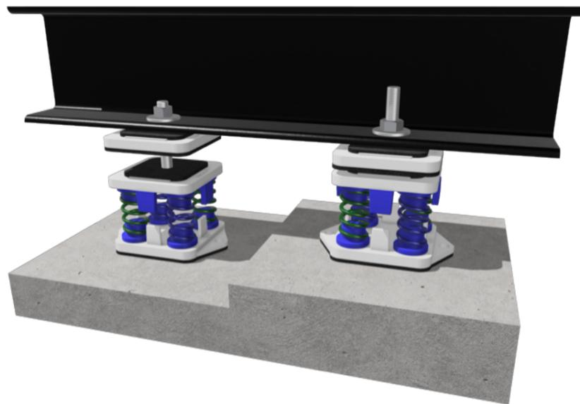
3. Fijamos la estructura o equipo al aislador con la arandela y la tuerca superior.
