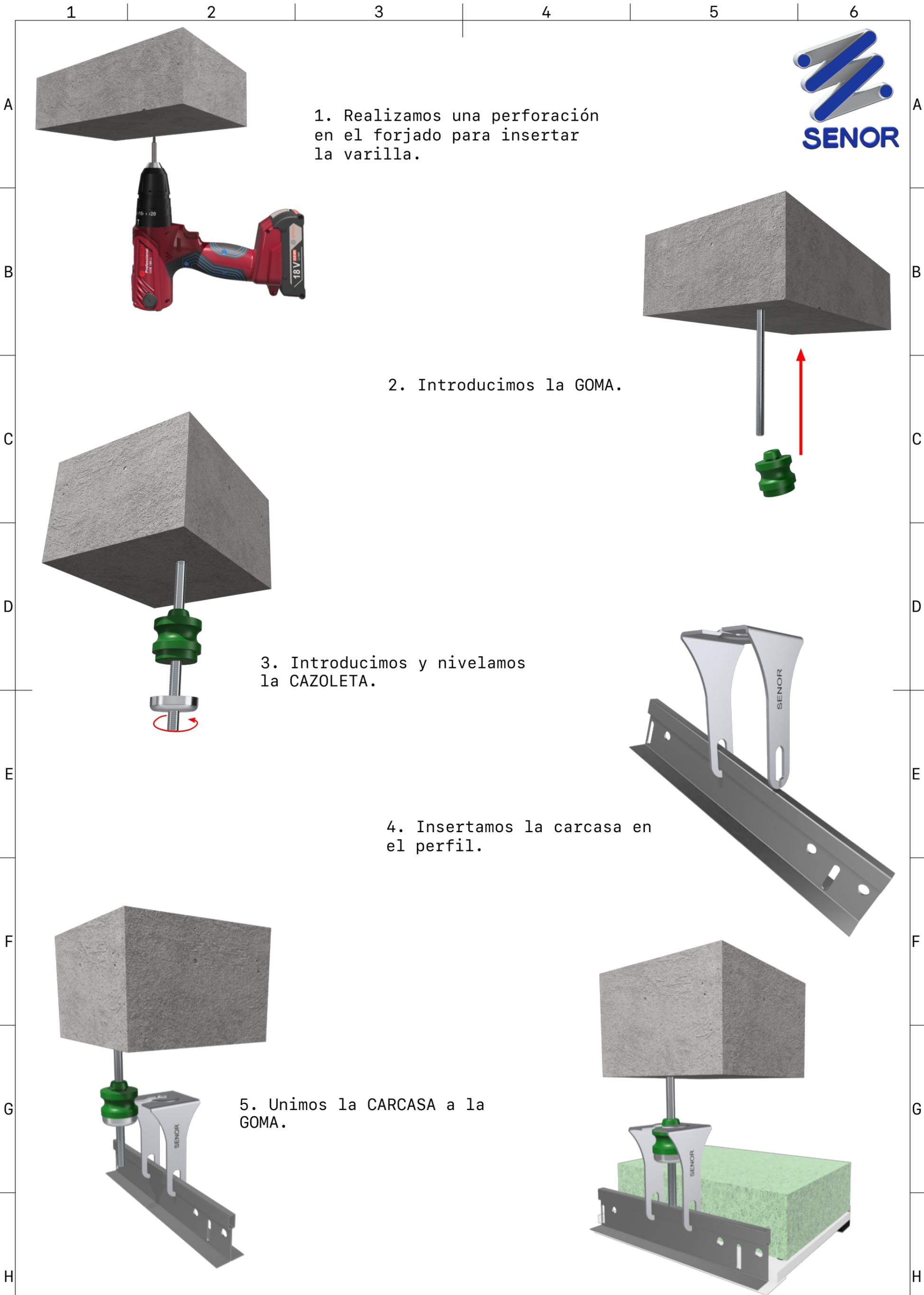
1. Realizamos una perforación en el forjado para insertar la varilla.
