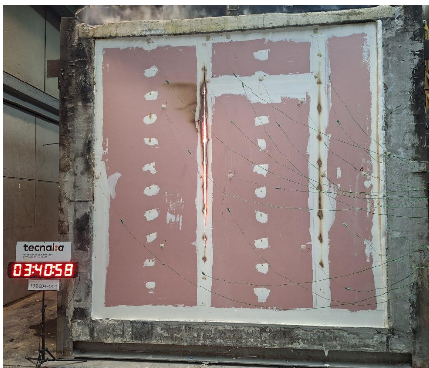
Photographies 38-39 : Apparence de l'échantillon à la fin de l'essai.
