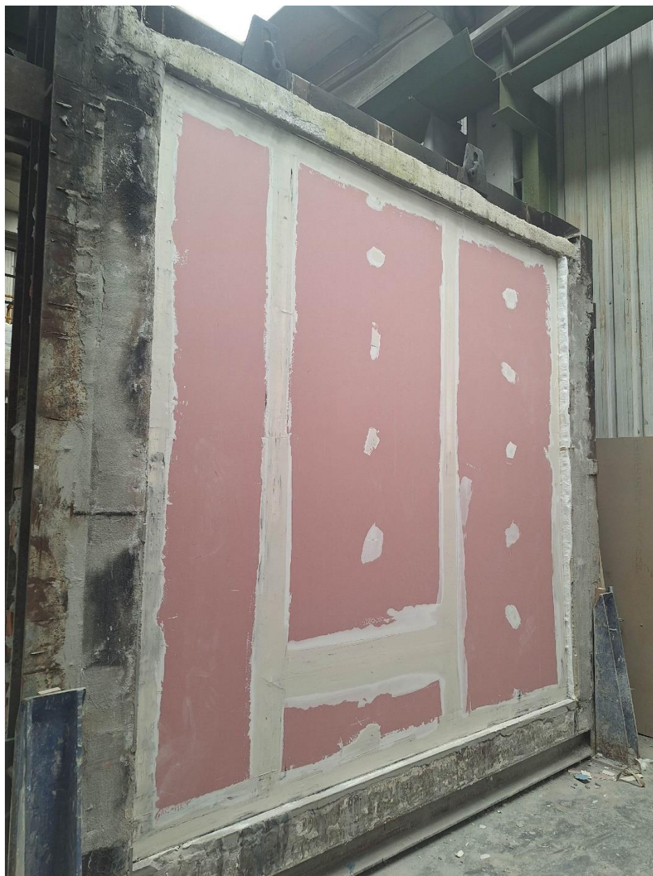
Photographie 28 : Aspect de l'échantillon avant l'essai, face exposée
