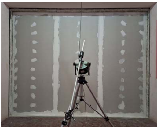
Fotos del trasdosado sobre pared en cámaras de ensayo
