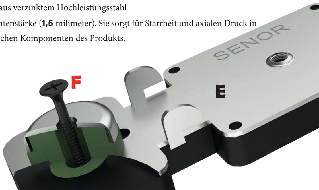
**F** SICHERHEITSVORRICHTUNG bestehend aus einer zentralen Stahlachse (Schraube) und eine Metallschale (CN). Im Falle eines Brandes verschwindet das Polymer, aber die mechanische Fixierung bleibt bestehen.
