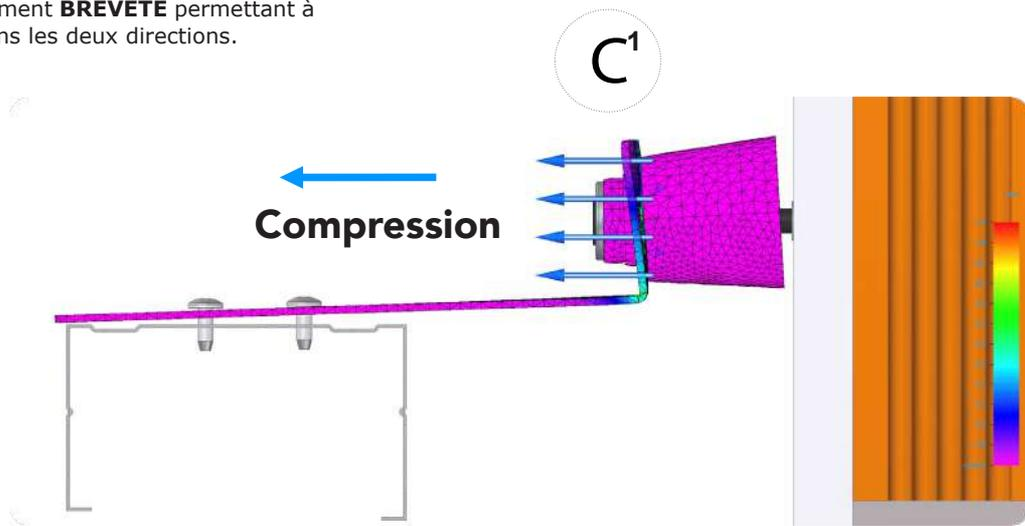
De cette façon, lorsque l'appui est fixé au mur à l'aide de vis et de rondelle en acier, il reste joint au mur et rend l'équerre en acier libre pour effectuer la compression du **CAOUTCHOUC** dans les deux sens. Voir détails C<sub>1</sub> et C<sub>2</sub>
