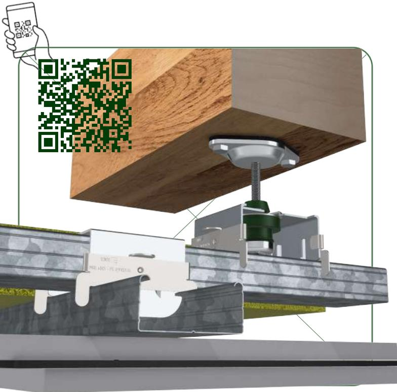
**Ossature métallique** emboutie selon la Norme **EN 10204/DIN50049 / ISO404**.
