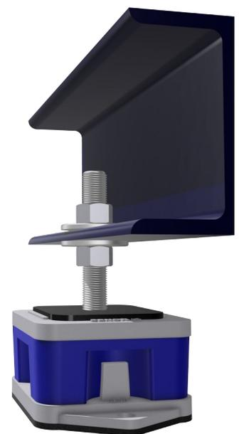
**3:** Fijamos la estructura o equipo al aislador con la arandela y la tuerca superior
