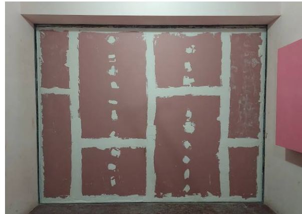
Fotos del trasdosado sobre pared en cámaras de ensayo
