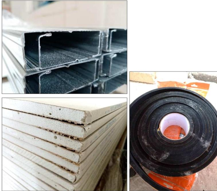
**Imágenes 7 a 9 Detalles de estructura, PYL y banda elástica**
