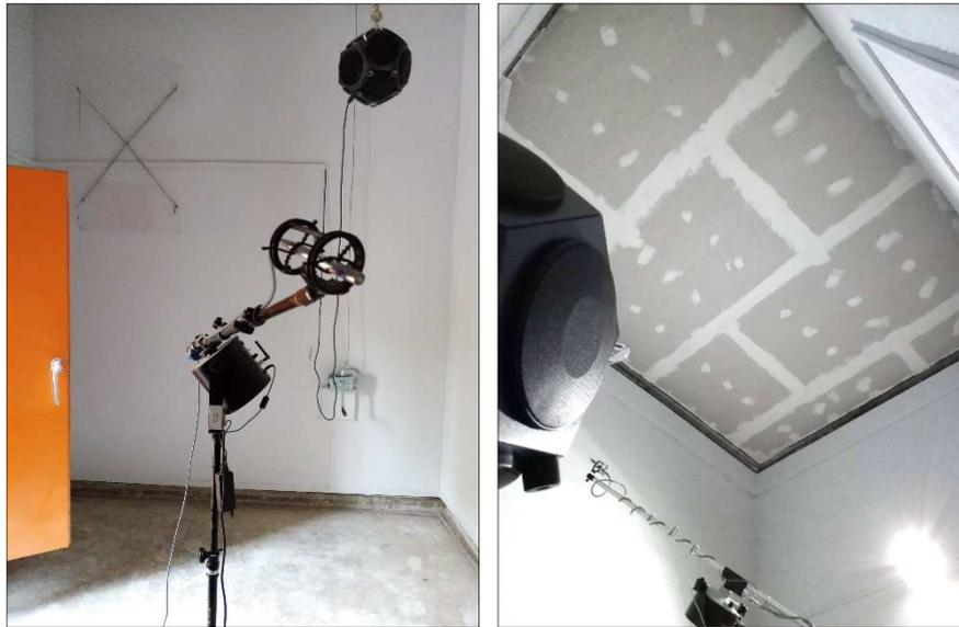
**Imágenes 22 y 23 Muestra instalada y lista para ensayo, vista desde la sala emisora y receptora**
