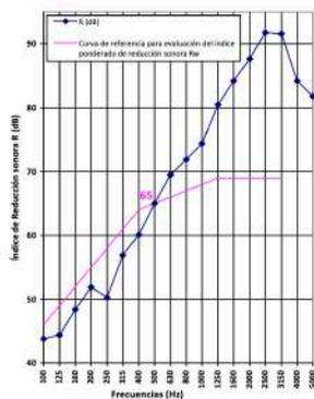
Índices según UNE-EN ISO 717-1:2013: R<sub>w</sub>(C;C<sub>1</sub>): 65 (-2; -7) dB
