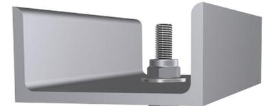
**3:** Fijamos la estructura o equipo al aislador con la arandela y la tuerca superior
