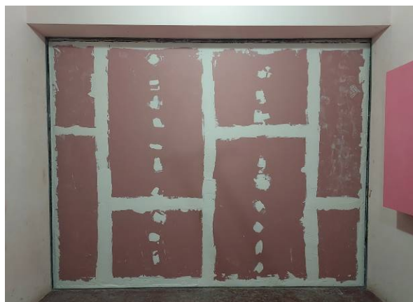
Fotos del trasdosado sobre pared en cámaras de ensayo
