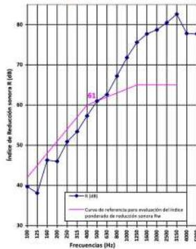
Índices según UNE-EN ISO 717-1:2013: R<sub>w</sub> (C;C<sub>50</sub>): 61 (-2; -7) dB
