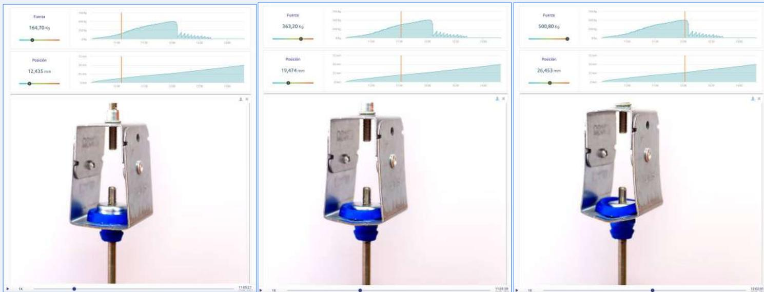
Disposición de ensayo: 164,70 Kg
