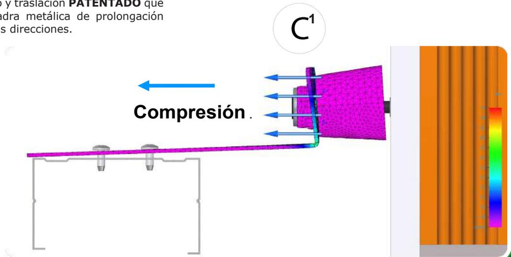
Al fijar el amortiguador al muro mediante el tornillo y la arandela a través del orificio central del polímero éste, queda totalmente fijado al paramento, permitiendo que la escuadra de acero quede totalmente libre pudiendo realizar la compresión de la **GOMA** en todas las direcciones. Ver detalle **C1** y **C2**.
