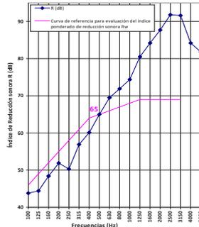
Índices según UNE-EN ISO 717-1:2013: R<sub>w</sub> (C<sub>w</sub>): 65 (-2; -7) dB
