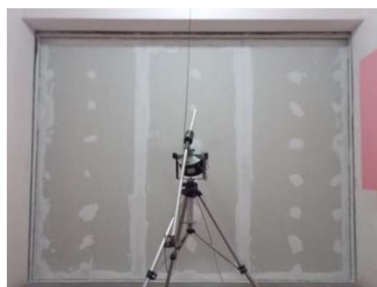
Photographies du la contre-cloison sur mur dans des salles d'essai
