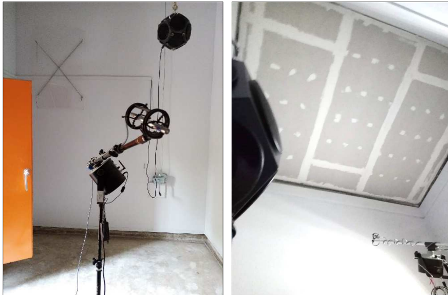
Images 28 et 29 Élément d'essai installé et prêt pour tester; salle d'émission et de réception
