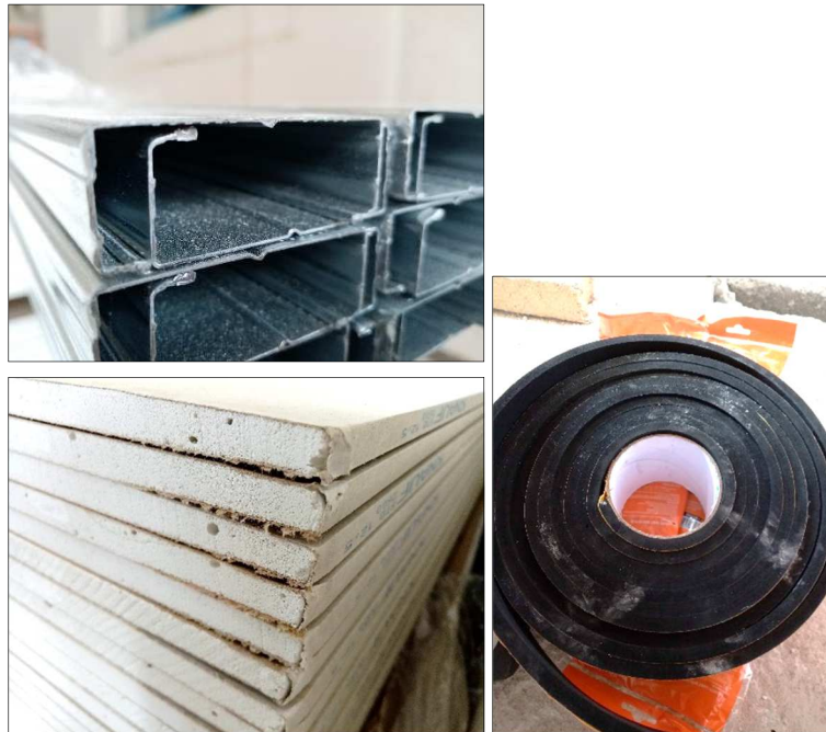
Images 9 à 11 Détails du ossature, plaque de plâtre cartonnées et bande d'étanchéité
