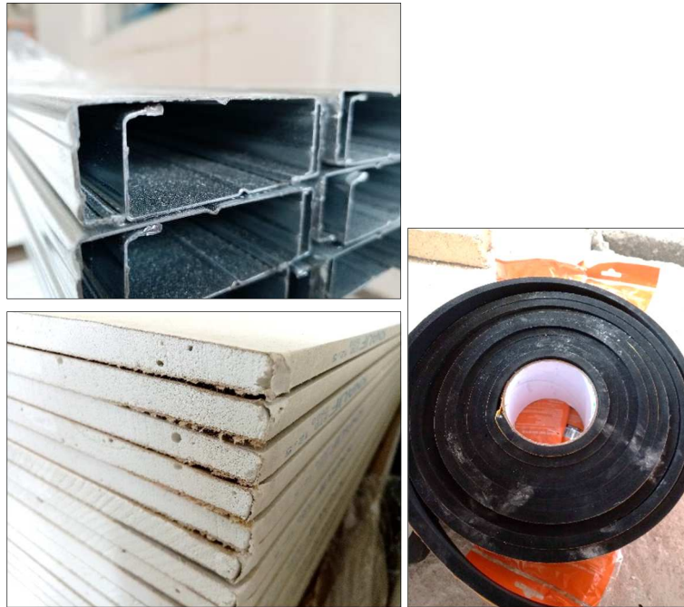
Images 7 à 9 Détails du ossature, plaque de plâtre cartonnées et bande d'étanchéité
