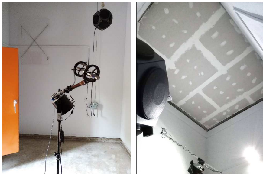
Images 22 et 23 Élément d'essai installé et prêt pour tester; salle d'émission et de réception
