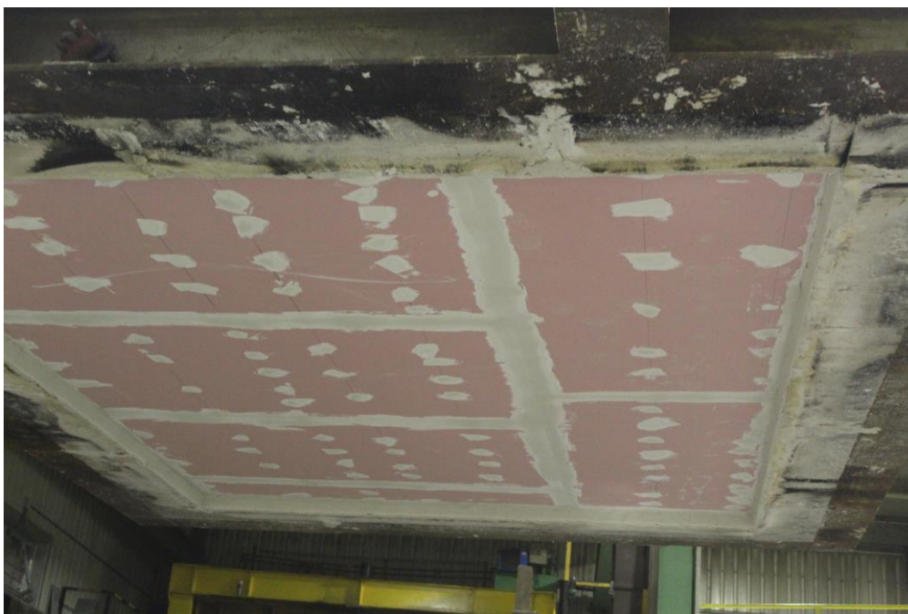
Fotografía 12: Aspecto de la muestra antes del ensayo, cara no expuesta.
