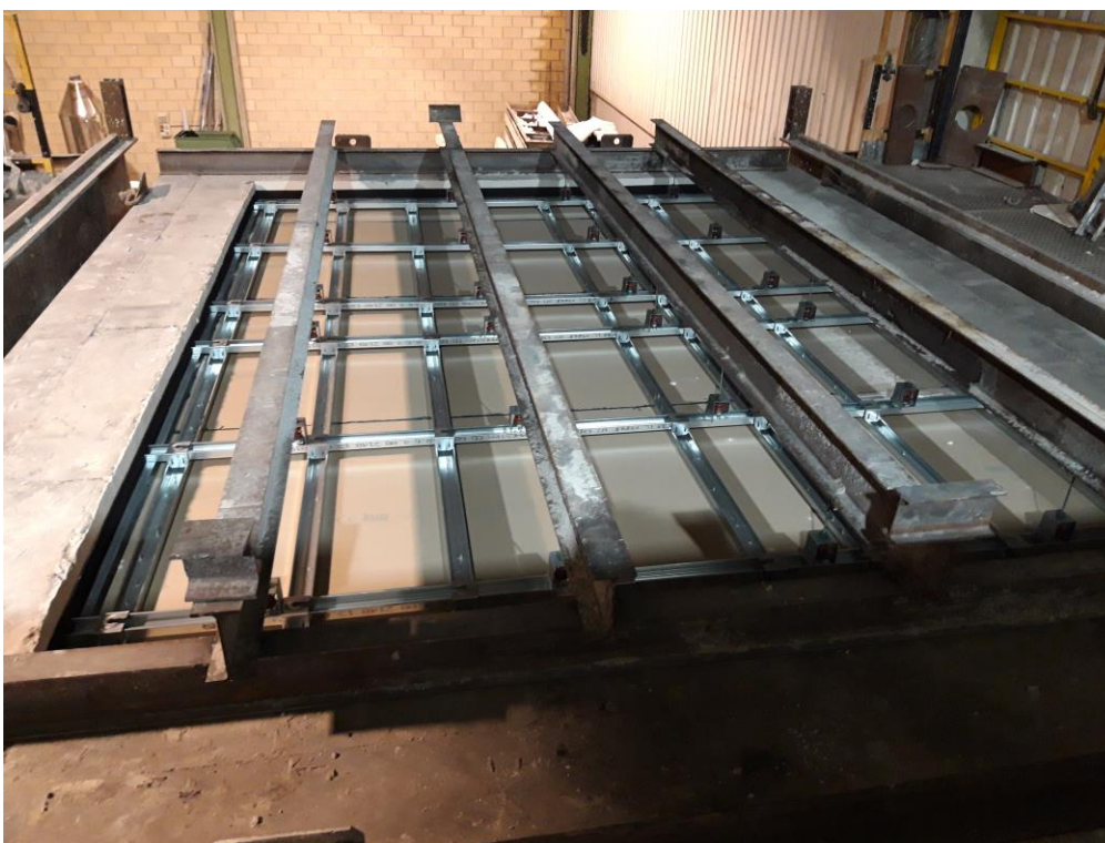
Fotografía 12: Aspecto de la muestra antes del ensayo, cara no expuesta.
