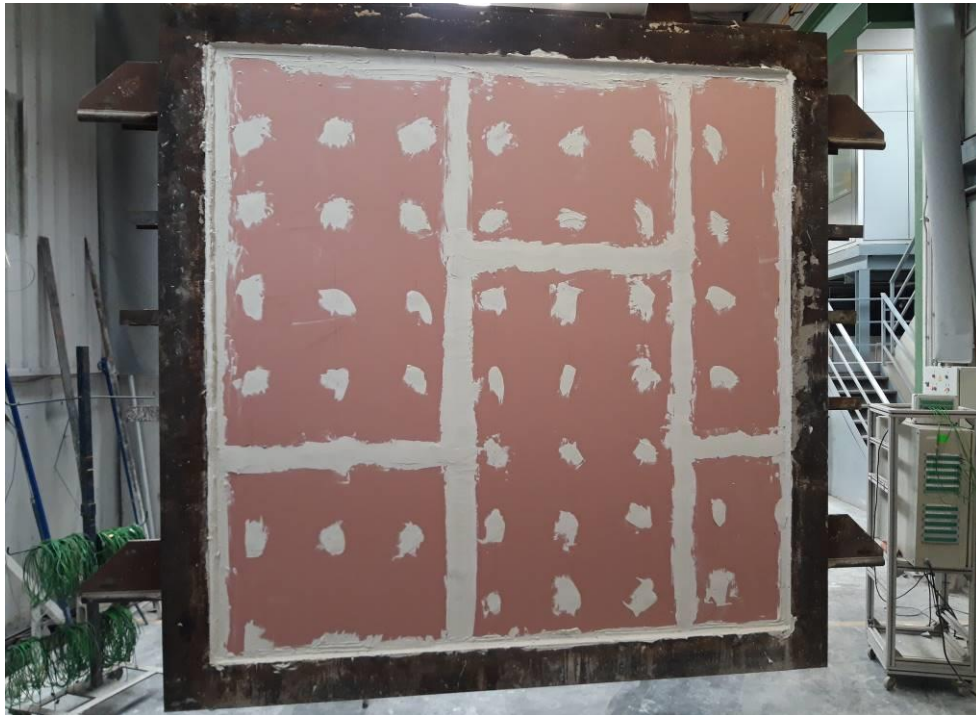
Fotografía 13: Aspecto de la muestra antes del ensayo, cara no expuesta.
