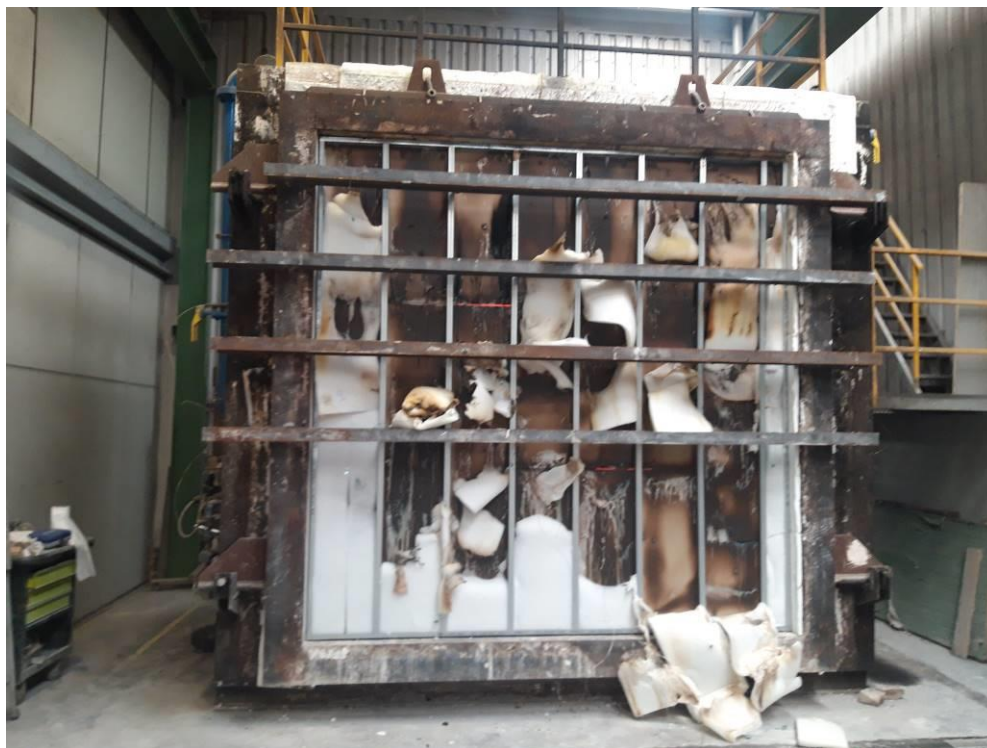
Fotografía 25-26: Aspecto de la muestra después del ensayo.
