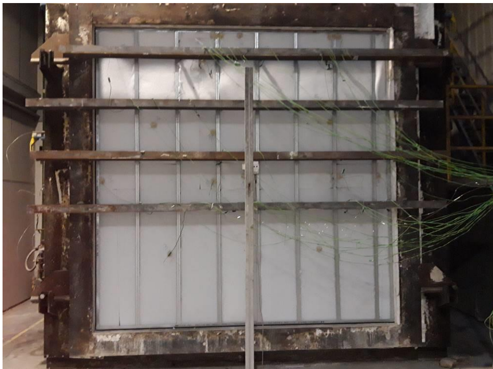
Fotografía 13: Aspecto de la muestra antes del ensayo, cara no expuesta.
