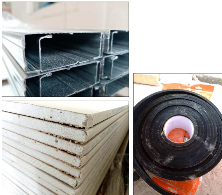
Imágenes 9 a 11 Detalles de estructura, PYL y banda elástica
