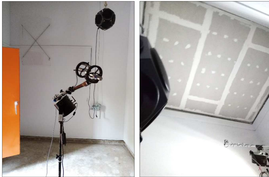
Imágenes 28 y 29 Muestra instalada y lista para ensayo, vista desde la sala emisora y receptora
