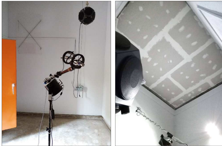
Imágenes 22 y 23 Muestra instalada y lista para ensayo, vista desde la sala emisora y receptora
