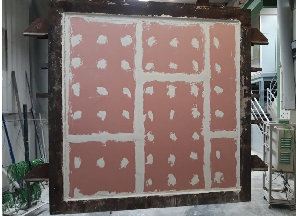
Photographie 13 : Aspect de l'échantillon avant l'essai, face non exposée
